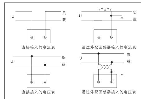
■ 44L1-Hz, 59L1-Hz, 69L13-Hz接线图
