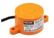
接近开关是一种具有开关量输出的位置传感器。它既有行程开关、微动开关的特性，同时又具有传感性能，可与微机联网、达到自动控制目的，也可直接驱动继电器、计数器及接触器。并且工作频率高、使用寿命长、抗干扰性能好，复位精度高(0.02cm)、输出形式多、防水、防震、防腐蚀。广泛应用于机械、纺织、轻工、冶金、造纸、印刷、包装、烟草、电力、矿山、铁路、航天、军工等行业。
