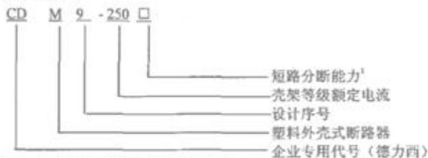
1: C—经济型, F—标准型, H—较高分断型, N—较高分断型热可调, C、F型除标牌不一样外, 其它完全相同, N、H型除标牌不一样以外, N型内部增加一个牵引杆, 热脱扣在 0.8In 0.9In 1.0In 范围内可以调节, 盖上有可调旋钮, 其他完全相同。
