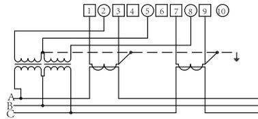
■ 三相三线电流互感器接入式接线图
