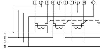
■ 三相四线直接接入式接线图
