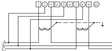
■ 三相三线直接接入式接线图
