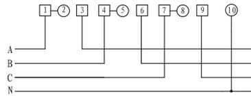
■ 三相三线电流、电压互感器接入式接线图
