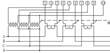
■ 三相四线电流互感器接入式接线图
