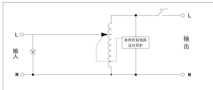
■ 单相15kVA~30kVA电气原理图
