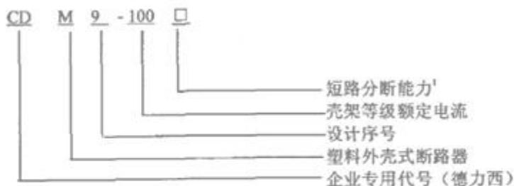
1: C—经济型, F—标准型, H—较高分断型, N—较高分断型热可调。C、F型除标牌不一样以外, 其它完全相同; H、N型和C、F型主要区别在于产品的高度、灭弧室、电磁系统、触头和牵引杆不同, N型热脱扣0.8In, 0.9In, 1.0In可以调节, 盖上有可调旋钮。
