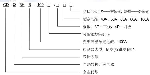
注 1: B型(标准型)控制器功能包括: 电网一电网、电网一发电、自投自复、自投不自复、互为备用、过压、欠压、失压、断相、延时可调、发电机控制、消防联动。
