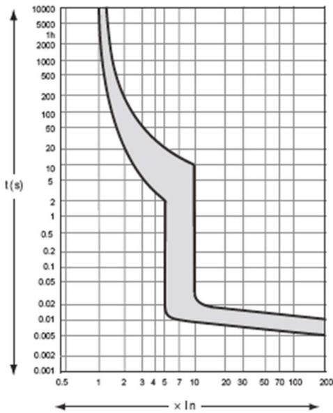
图 1 C 型热/电磁脱扣特性曲线
