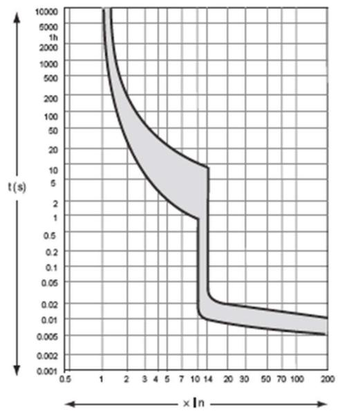
图 2 D 型热/电磁脱扣特性曲线
