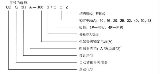
注 1: A型(经济型)控制器功能包括: 电网一电网、自投自复、过压、欠压、失压、断相、延时可调、消防联动。
