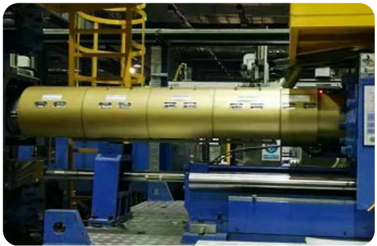
4) 注塑机更换纳米红外加热线圈
