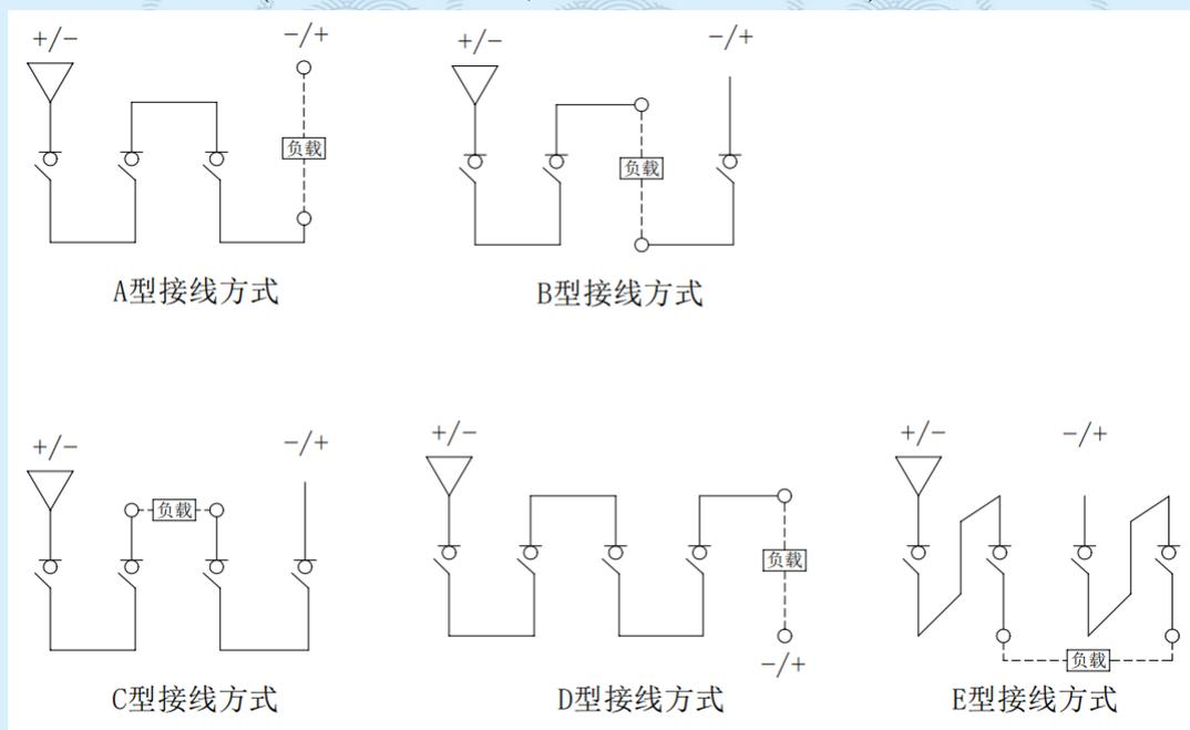
注: 以上五种接线方式无极性要求, 并且同时适用于上进线和下进线的接线方式。
